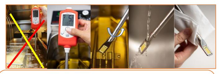
待油槽穩定無懸浮物,按開機鍵,插入油槽開始測量,離槽底約 1-2 公分順時鐘方向攪動約 30 秒內讀值顯示 5%TPM 閃爍亮綠燈,同時顯示油溫溫度 162.7℃,用熱水沖洗咸測電極後,擦拭乾淨即可再次測量.
